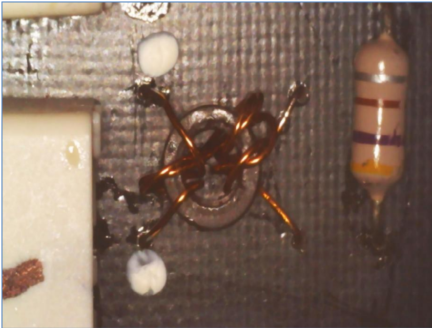
Detail vř transformátoru na toroidním jádře
