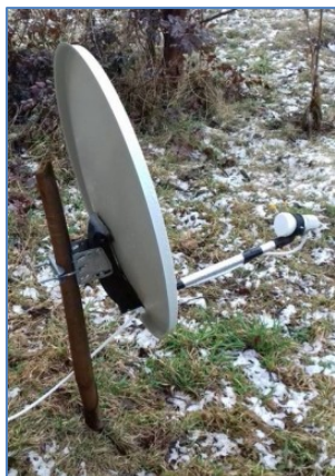
Pro začátek lze anténu připevnit na obyčejné vidle. Foto Michal Grygárek.
