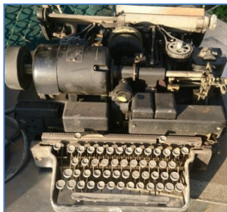
◀ Mechanický dálkopis anglické firmy Creed z doby krátce před 2. světovou válkou.
