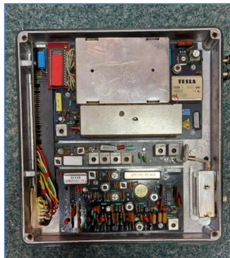
Pohled do vnitřku radiostanice. Nahoře pod plechovými kryty kmitočtová ústředna, vlevo nahoře přidaná destička s pamětí RAM označená červeným štítkem, dole přijímač na dvou deskách.
