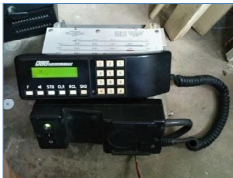
AMR s inovovanou ovládací skříňkou. Většina ovládacích prvků je na mikrotelefonu.
