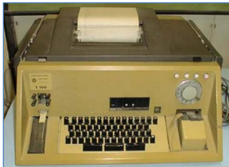
Dálkopisný stroj T100, vyráběný ve Zbrojovce Brno v licenci Siemens od roku 1974. Originál Siemens T100, vyráběný v Německu, byl uvnitř stejný, ale v jiné skříni. Tento stroj používal dvojbarevnou pásku, jinou barvou tiskl přijatý text, jinou vyslaný.
