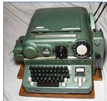
Dálkopisný stroj D302 Dalibor. Původní československá konstrukce, vyráběná od roku 1959 ve Zbrojovce Brno. Používal se převážně u armády.
